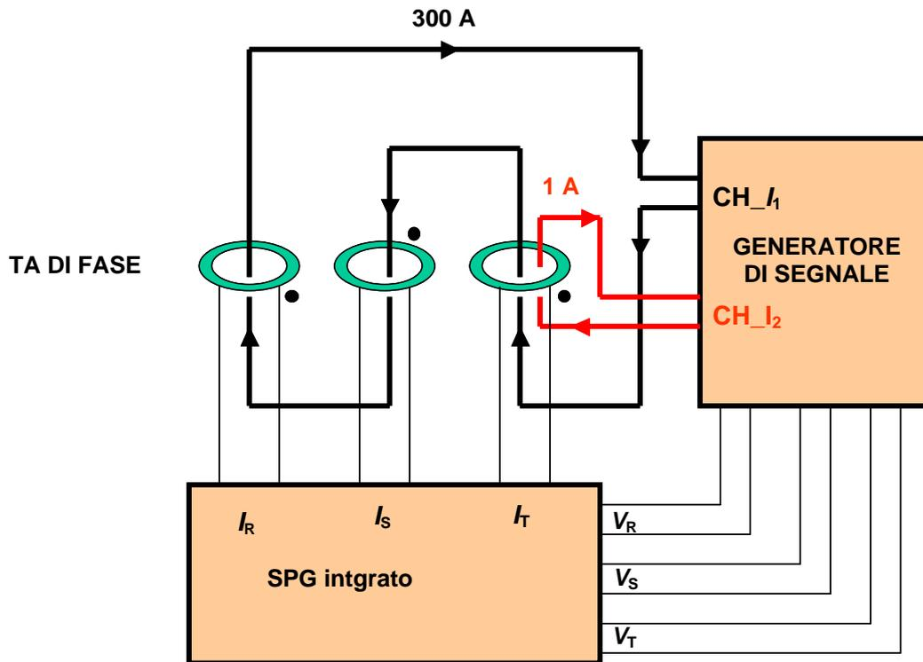
**Figura 27 – Schema di prova per la verifica della precisione della soglia direzionale del SPG integrato con 3 sensori di corrente di fase, in presenza di elevate correnti di carico**
