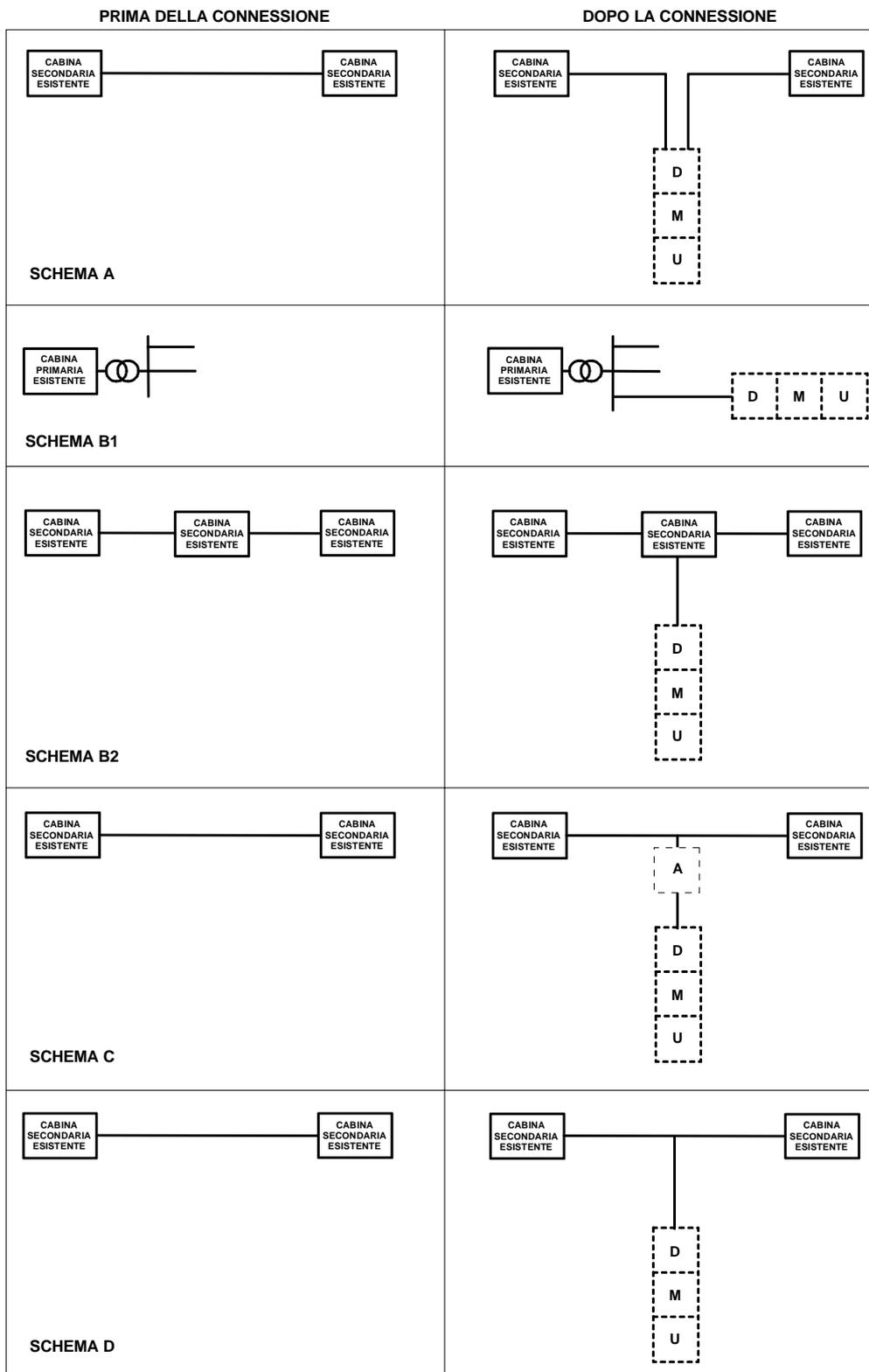
**Figura 18 – Schemi di inserimento dell'impianto di Utente**
