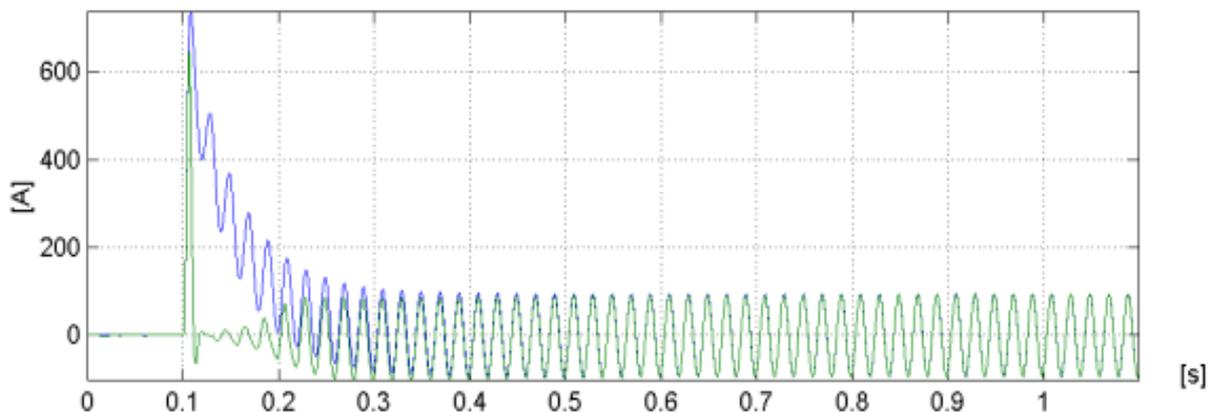
**Figura 26 – Corrente secondaria convenzionale per TA omopolari (TO)**
