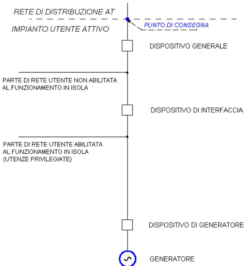
**Figura 17 – Configurazione generale dell'impianto d'utenza attivo**
