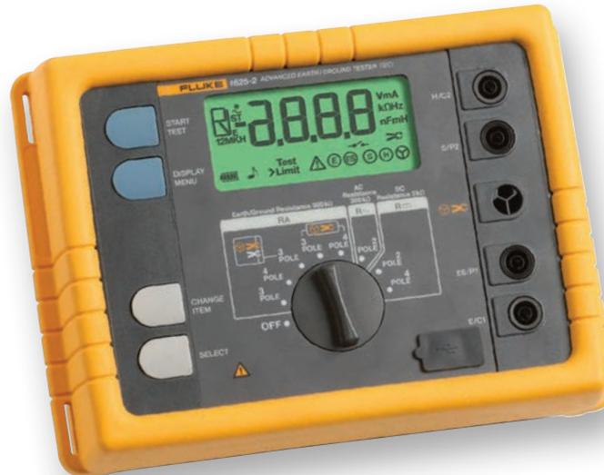
as resistências do loop de aterramento usando apenas alicates. Com esse método de teste, dois alicates são colocados na haste de aterramento, e cada um deles é conectado ao testador. Não são usadas estacas de aterramento. Uma tensão conhecida fixa é induzida por um alicate, e a corrente é medida usando o segundo alicate. Em seguida, o testador determina automaticamente a resistência da haste de aterramento.
