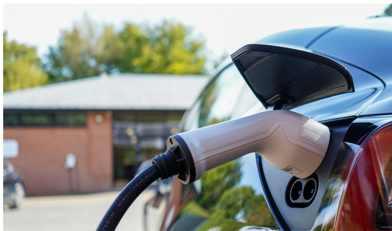
Tomada de carregamento CCS COMBO 2 de um carro elétrico com conector Tipo 2 conectado.
