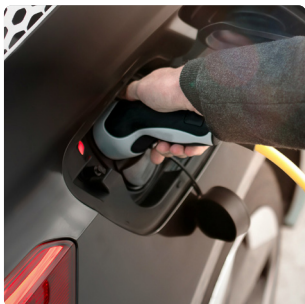
Tomada de carregamento de um carro elétrico com conector Tipo 2.
