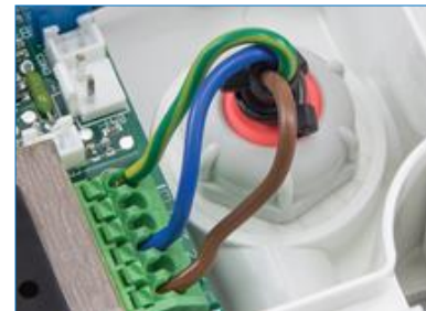
Conector rápido 12mm 2 & Entrada/Saída. (BeamTech & BeamLite II)
