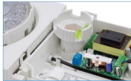
Entrada de cabo e ferramenta de aperto. (BeamTech)
