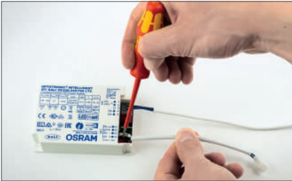
Passo 2: Ligue os cabos ao driver DALI dim
