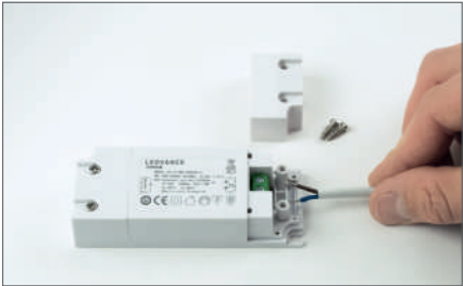
Passo 1: Desparafuse o topo e os cabos do driver
