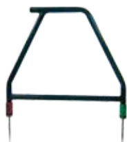
Arco A-Frame Para determinar a posição do defeito do cabo
