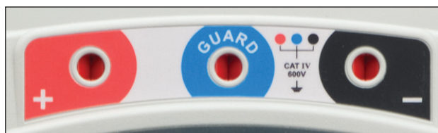
Figura 30: Los modelos MIT de Megger aseguran que la especificación CAT se aplica a todos los terminales por razones de seguridad. Algunos de los instrumentos en el mercado hoy en día son engañosos.
