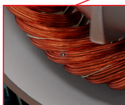
Enfraquecimento do isolamento entre laços
