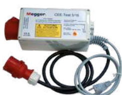
Adaptador trifásico CEE de prueba 5/16 Adaptador CEE activo con medición de corriente diferencial para pruebas de corriente trifásica trifásicas hasta 16 A (DE-050) o hasta hasta 32 A (DE-051)
