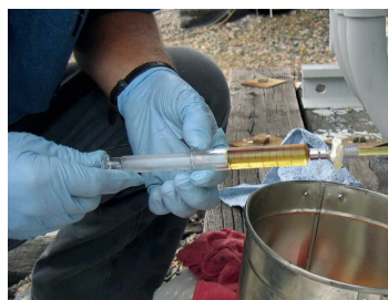
3 – Não puxar o êmbolo da seringa – deixar que a pressão do óleo encha a seringa, aplicando uma resistência suave no êmbolo
