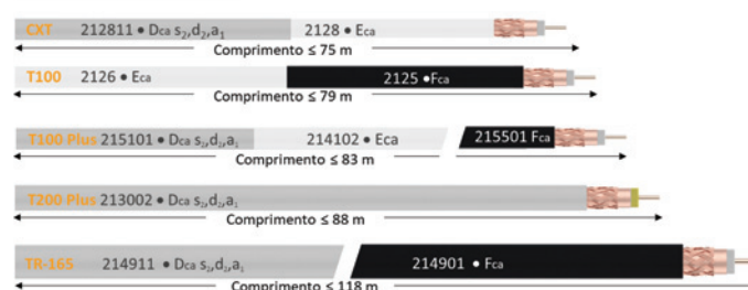
Figura 1. Comprimentos máximos do cabo coaxial em função dos limites de atenuação e Slope do ITED 4.
