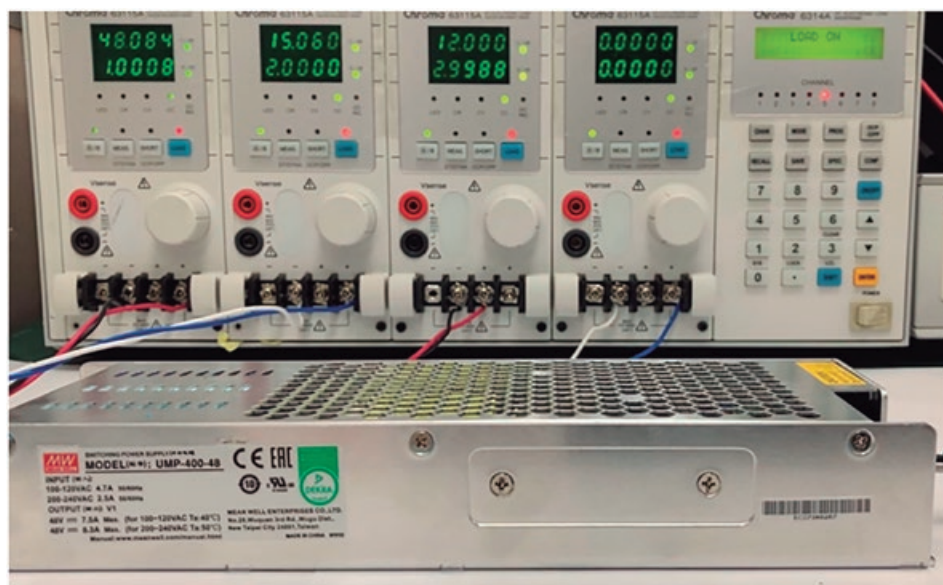
Figura 2. UMP-400-48KJ. Prova de voltagem.
