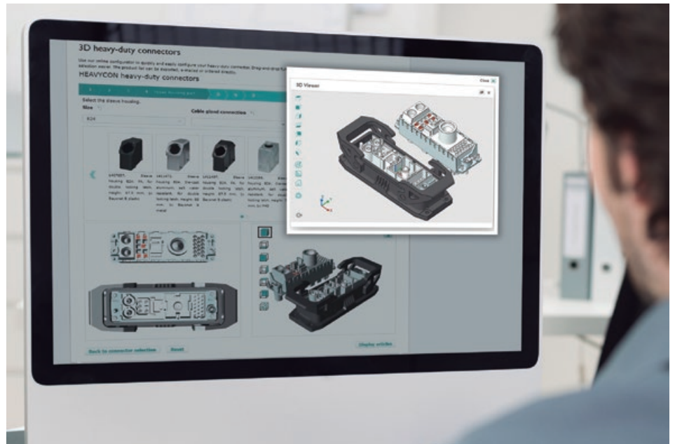
Figura 4. Flexibilidade no desenvolvimento: após terminar a configuração pode exportar o modelo em 3D para importação CAD.
