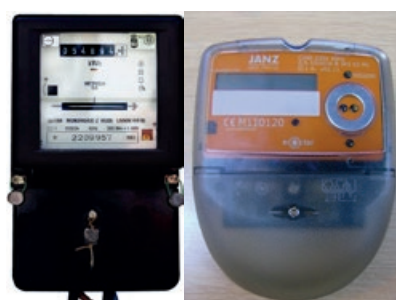
Figura 12. Contador electromecânico (esquerda) e contador digital (direita).
