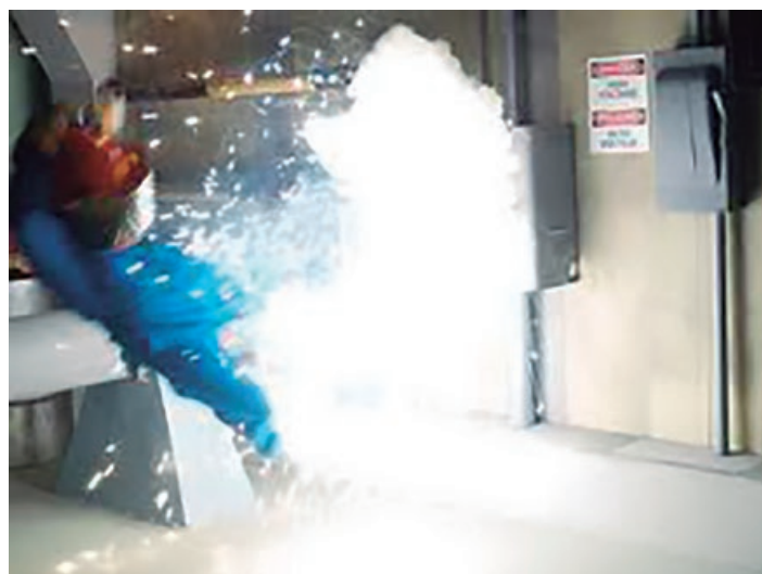
Figura 5. Trabalhador atingido pelo ar soprado na sequência de um arc flash .
