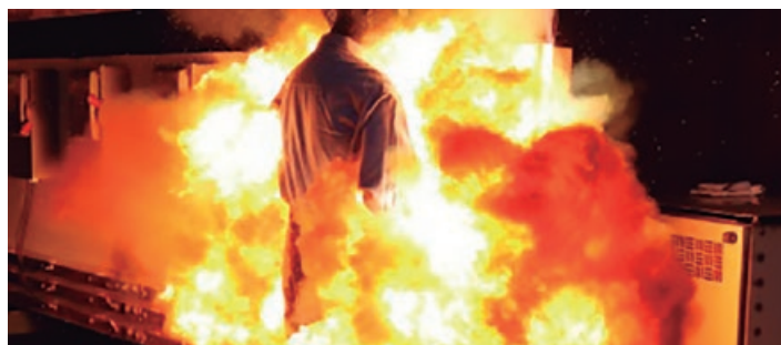
Figura 2. Incêndio devido a um arc flash.
