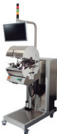
Figura 3. O sensor do sistema DualVision ProfilControl 7 fornece informações de superfície e dados dimensionais. © Pixargus
