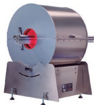
Figura 2. Pixargus combina tecnologia de teste comprovada para inspeção de superfície e medição geométrica para modelos de tamanho reduzido otimizados em termos de custos. © Pixargus
