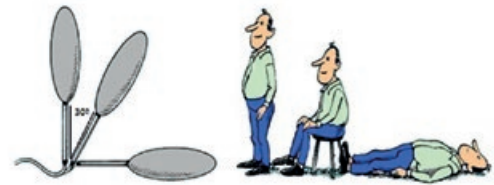
Figura 6. Posição do sensor elipsoidal segundo posição da pessoa a medir (Adaptado)[10].
