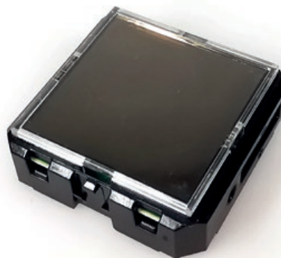
Figura 2. O multissensor STM 550 da EnOcean para aplicações de automação residencial e IoT é autoalimentado graças à recolha de energia.
