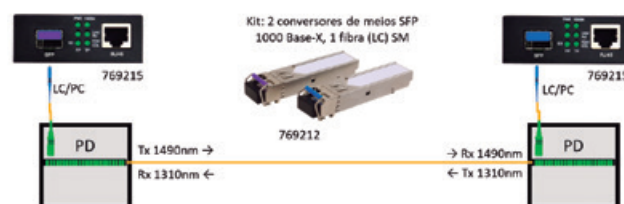
Figura 2. Transmissão P2P com 1FO SM com Kit SFP.
