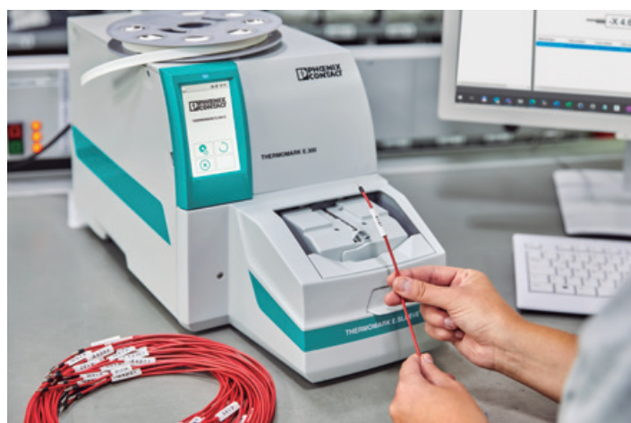
Figura 3. O aplicador Thermomark E.Sleeve processa mangas retráteis em formato contínuo, corta-as individualmente para o comprimento desejado e, em seguida, abre as mangas retráteis para que possam ser facilmente deslizadas para objetos cilíndricos.
