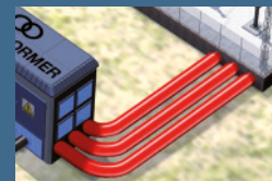
⑤ Cabos para o circuito de evacuação (MT/AT)
