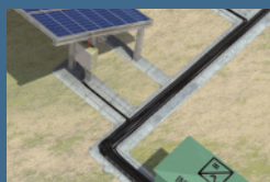
③ Instalação BT DC entre caixas de ligação e inversores
