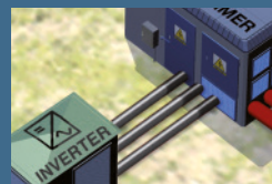
④ Instalação BT AC entre inversores e transformador
