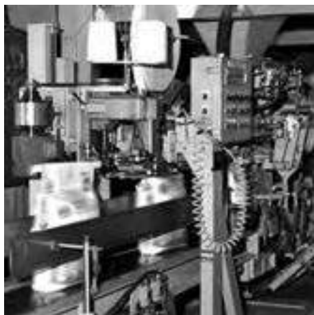
Servovariador Lexium 32 a controlar uma máquina de embalagem
