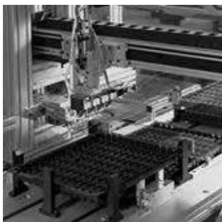
Servovariador Lexium 32 a controlar uma aplicação de manipulação
