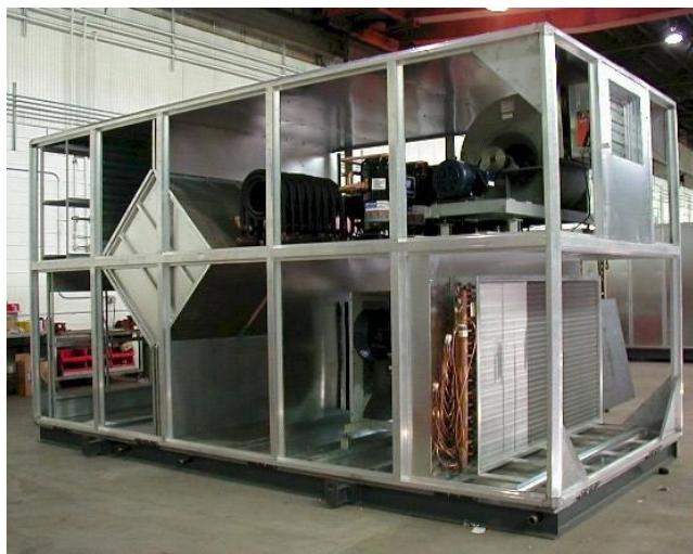
Unidade de tratamento de ar com recuperação de calor
