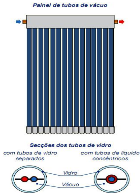
Fig.2.3. Painel de tubos de vácuo [Doninelli et al, 2006] pp.7.
