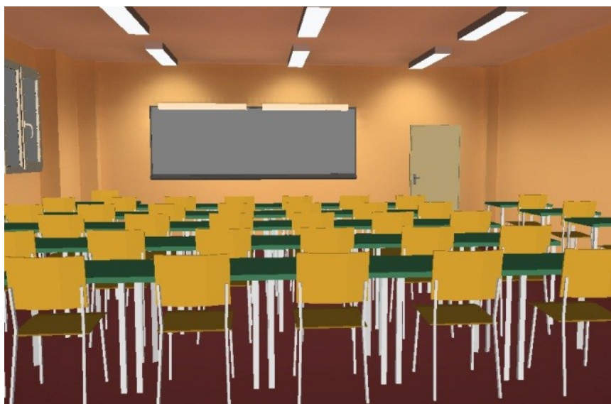
Figura 5.4 – Simulação, efetuada pelo DIALux, do sistema de iluminação artificial existente na sala E 1.02
