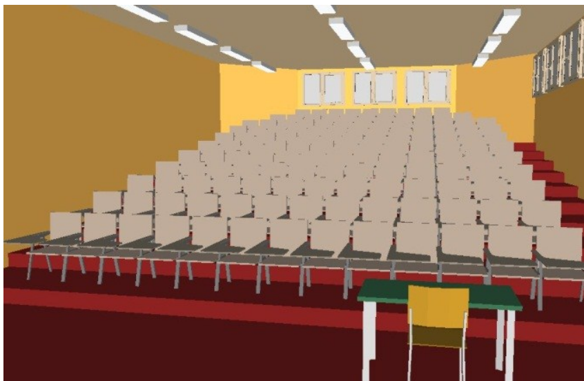
Figura 5.10 – Simulação, efetuada pelo DIALux, do sistema de iluminação artificial existente no anfiteatro G 0.03.
