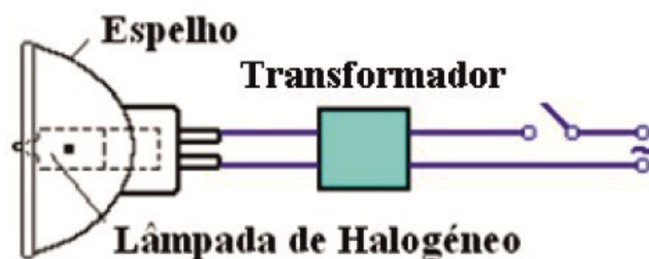
Figura 3.15 - Constituição e operação das lâmpadas de tungsténio com refletor de baixa tensão [Fonte: (Teixeira, 2006)].
