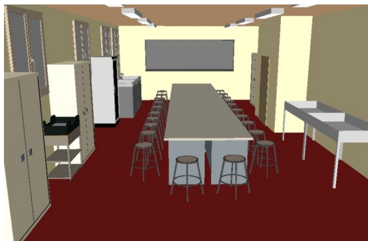
Figura 5.8 – Simulação, efetuada pelo DIALux, do sistema de iluminação artificial existente no laboratório de termodinâmica I 1.02.
