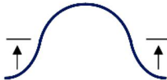
Enchimento de vales
