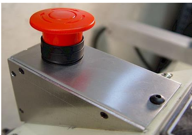
Figura 1 – Exemplo de uma botoneira de paragem de emergência de um motor
