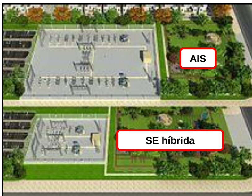
Figura 6 – Comparação de espaço entre uma SE AIS e uma SE híbrida
