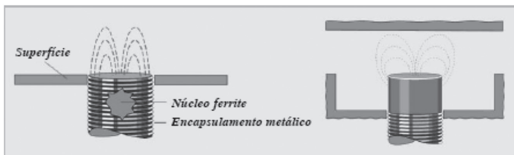
Figura 9 - Sensores indutivos com e sem encapsulamento metálico
