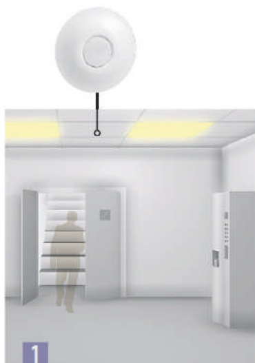
Entrada na sala O detetor liga-se automaticamente
