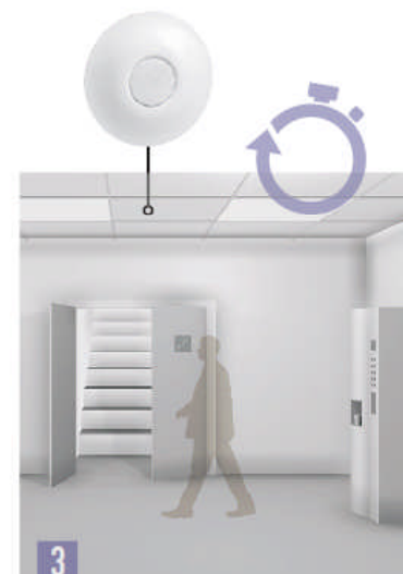
Sair da sala O detetor desliga automaticamente momentos depois de não detetar presença
