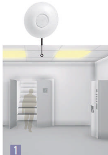
Entrada na sala O detetor liga-se automaticamente
