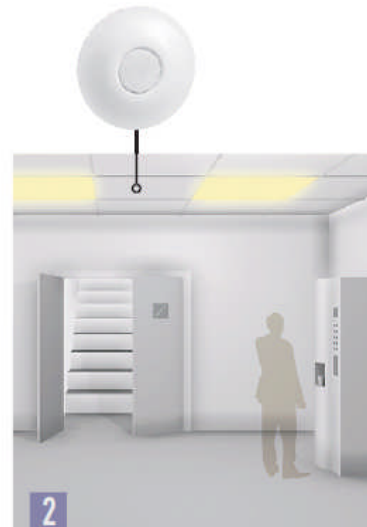
Matem-se na sala O detetor mantém a luz ligada ao detetar presença
