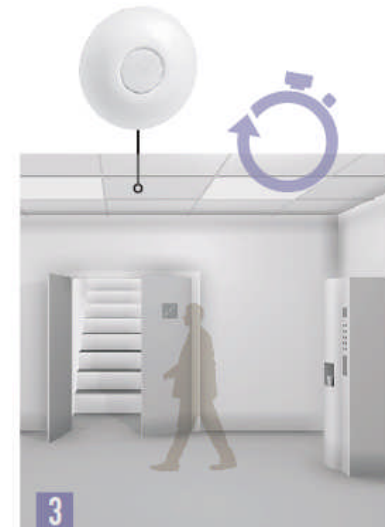
Sair da sala O detetor desliga automaticamente momentos depois de não detetar presença
