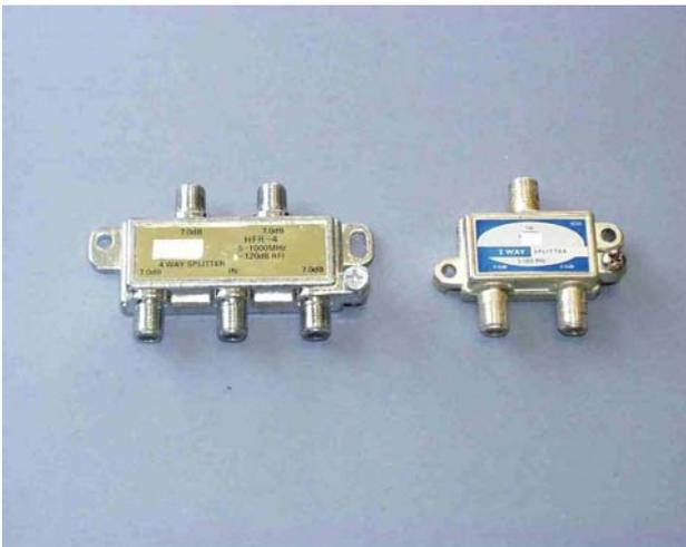
Figura 10 - À esquerda TAP terminal de 4 vias; à direita TAP terminal de 2 vias
