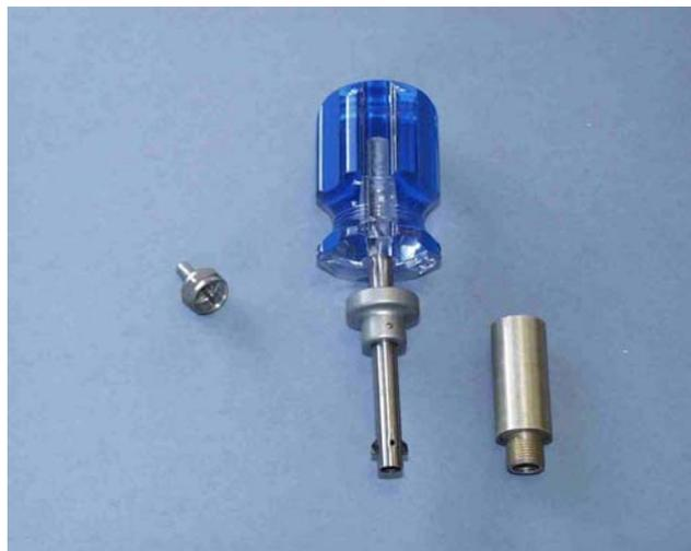
Figura 3 - Lado esquerdo carga simples; lado direito carga inviolável; ao centro chave para cargas invioláveis
