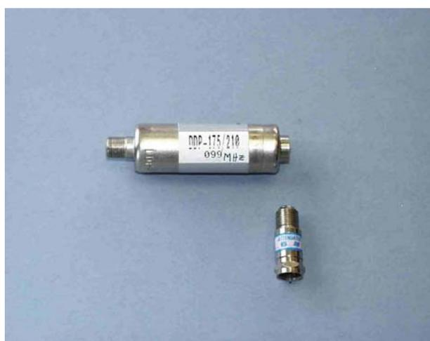
Figura 15 - Em cima filtro supressor de banda(175 a 210 MHz);
