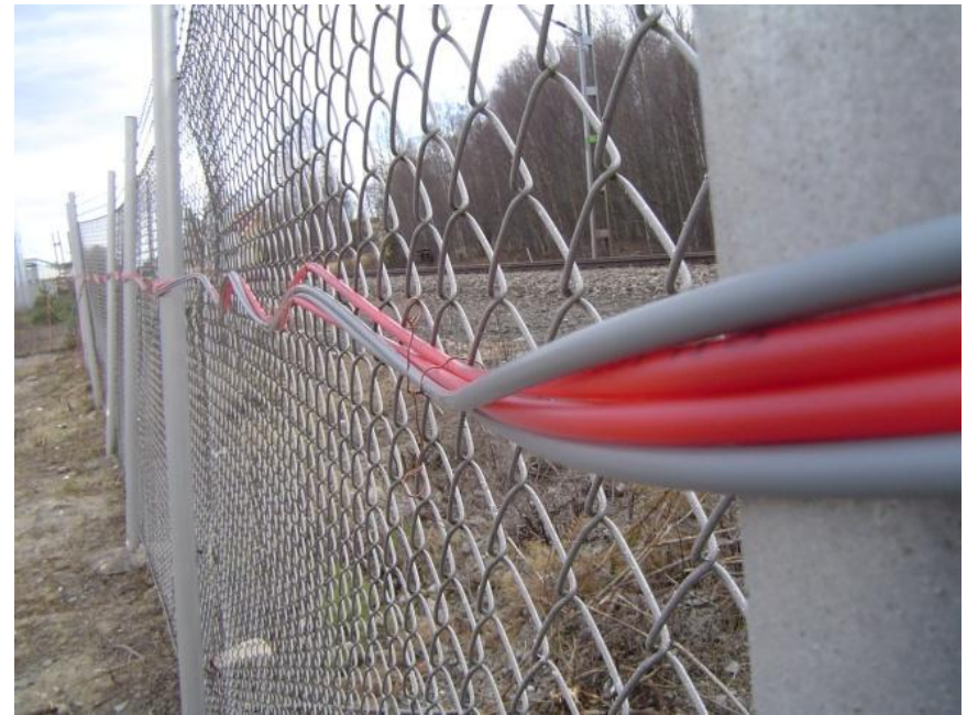
”Sinus” icke-standard test bana (340m) Amplitude=5 cm, Våglängd: 20-30cm
