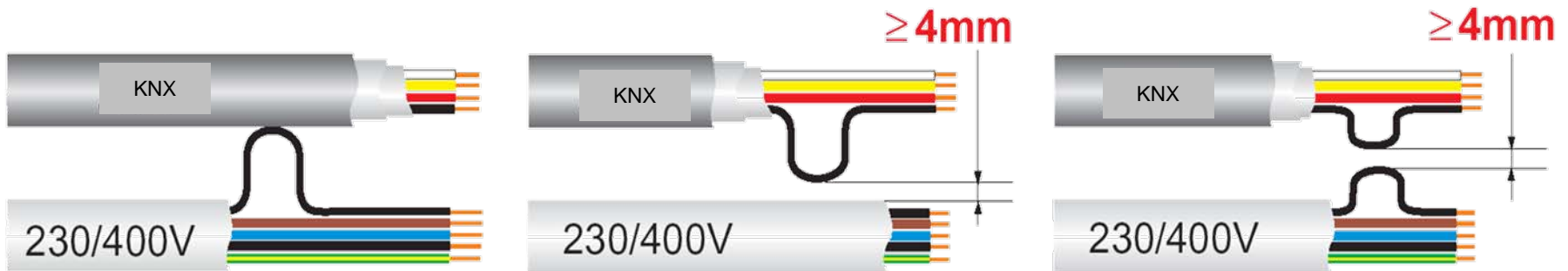
Fig. 2: Avstånd mellan KNX-kabel och elledning
