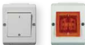
Strömställare för utanpåliggande montage, 16A, 250V, IP55. Lysrörslast 10A.
