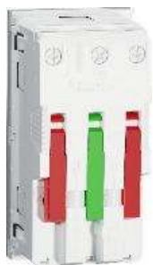
2-vägsuttag med "IPT" (skalningsfri anslutning EK och FK 1,5-2,5mm 2 )
