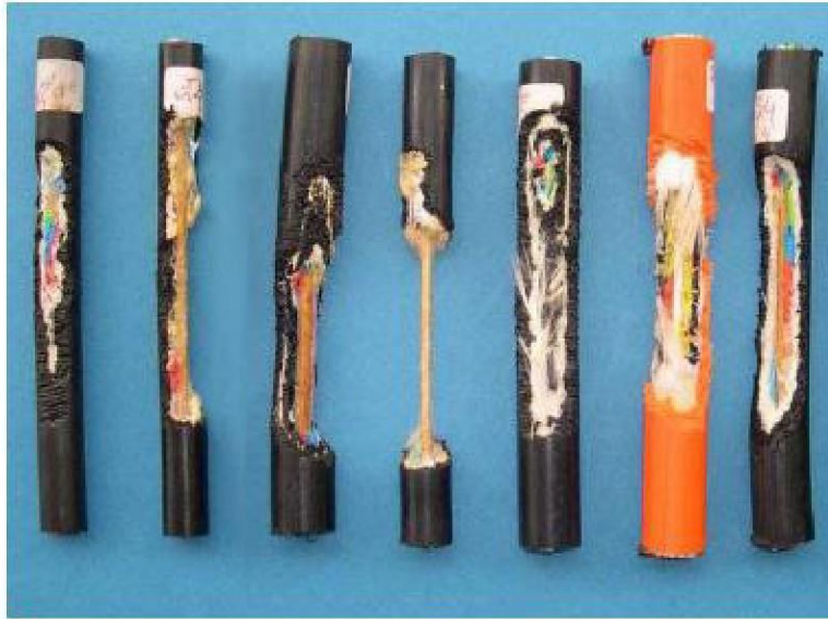
Resim 1: Kemirgen saldırısına uğramış kablolar
