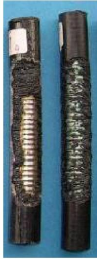
Resim 3: Kemirgen saldırısına maruz kalan zırlı fiber optik kablo
