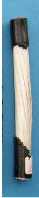
Resim 7: Kemirgen saldırısına maruz kalan, cam iplik korumalı optik kablo
