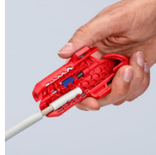
NYM kablosu dış kılıfını soyma
