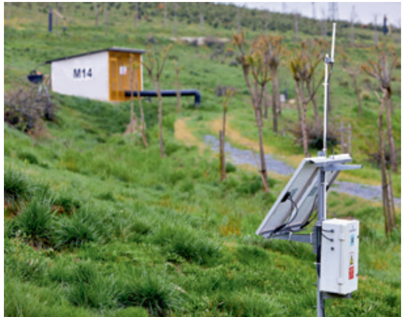
Resim 3: 68 toplama noktasından biri. Güneş panelleri sisteme güç vermekte...
